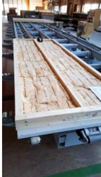
De la laine de verre Isover dans un élément de construction en bois préfabriqué ©Blumer-Lehmann AG
