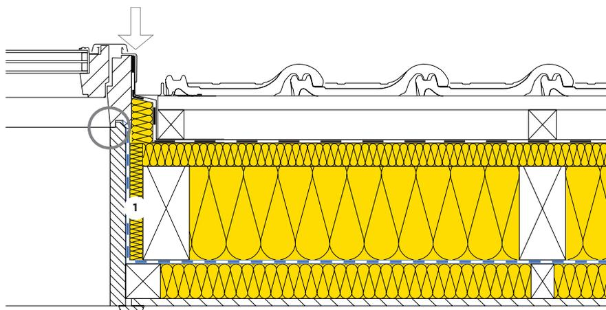
↓ **Isolamento termico** : punto di riferimento per il calcolo del valore  $\psi$
