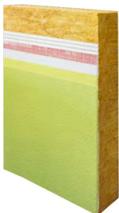
Il sistema di isolamento intonacato consiste nell'incuneare e ancorare i pannelli isolanti sulla parete di supporto da isolare, quindi nel rivestire questo isolante in più passaggi per ottenere la finitura. Nel sistema viene integrata un'armatura per garantire resistenza meccanica all'insieme.
