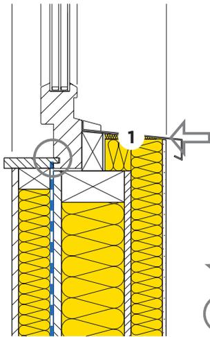
↓ **Isolamento termico:** punto di riferimento per il calcolo del valore  $\psi$
