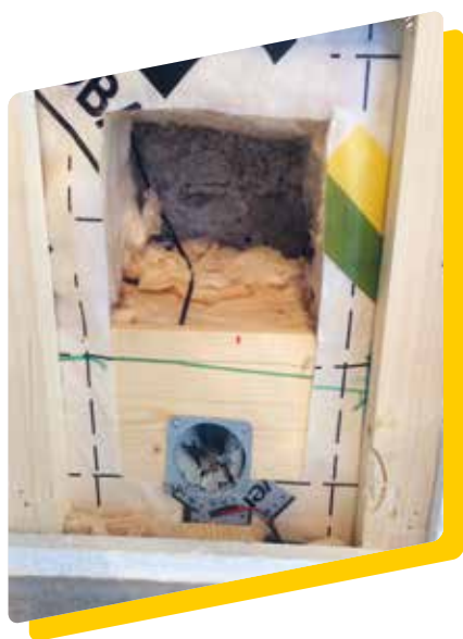
Fig. 22 : Démontage des sondes de mesure dans le bâtiment « Brüttelen » (voir page 30) après le quatrième hiver : aucune prolifération de moisissures n'a été constatée. La laine de verre Isover ne présente aucun changement, ni au niveau de sa forme, ni au niveau de son aspect.
