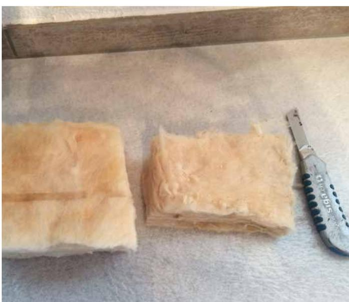
Fig. 21: Démontage des sondes de mesure dans l'objet «Brüttelen» (voir page 30) après le quatrième hiver: Aucune moisissure ne peut être détectée. La laine de verre ISOVER ne présente aucun changement de forme ou d'aspect.
