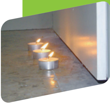
Brennende Kerzen machen Luftströmungen sichtbar.
