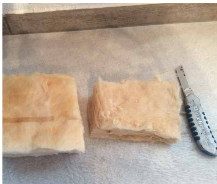
Abb. 21: Ausbau der Messsonden im Objekt «Brüttelen» (siehe Seite 30) nach dem vierten Winter: Es kann kein Schimmelpilzwachstum festgestellt werden. Die ISOVER-Glaswolle weist weder in der Form noch optisch Veränderungen auf.
