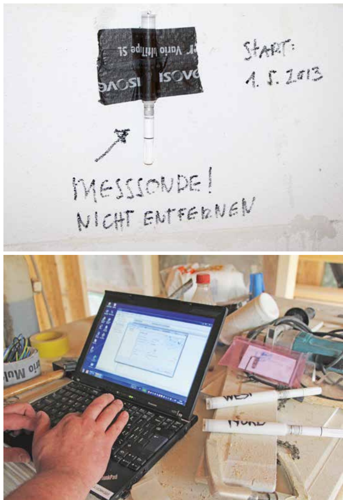
Abb. 26: Die aufgezeichneten Temperaturen und Luftfechtigkeiten werden über Funk ausgelesen.
