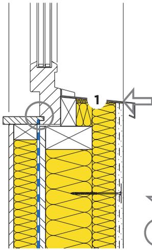
↓ **Isolamento termico:** punto di riferimento per il calcolo del valore  $\psi$
